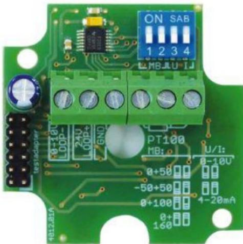
Temperatur-Messumformer zum Anschluß eines PT100-Sensors in Dreileiterschaltung. Wählbare Messbereiche: 0..50°C, -50..+50°C, 0..100°C und 0..160°C. Wählbares Ausgangssignal: 4-20mA oder 0-10V.
